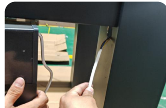
8. 有线一头先进入，注意电线防止压断
