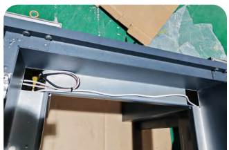
9. 电线从水槽，接线处要抹好玻璃胶
